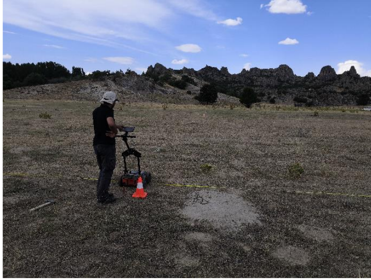
Foto 16. Konya Bağirsak Boğazı'nda Yapılan Jeoradar Çalışması.
